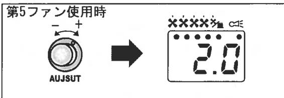
**2** アジャストダイヤルを回して、温風ヒーターの運転停止温度を設定します。
