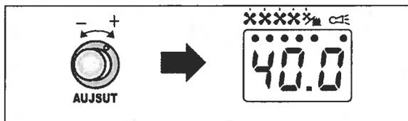
**2** アジャストダイヤルを回して、最低回転速度を設定します。
