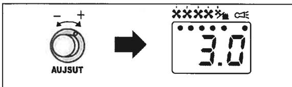
**2** アジャストダイヤルを回して、第2ファンの最大回転速度の到達温度を設定します。
