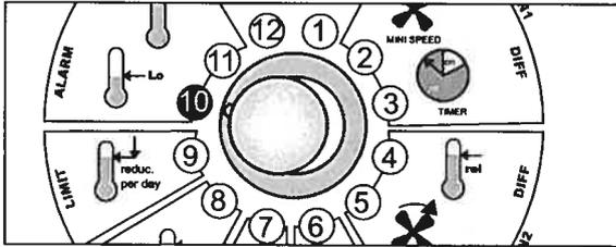
機能セレクトダイヤルを、異常温度警報設定ゾーンの機能番号⑩に合わせると、第1機能設定ステージの全機能の設定が完了し、現在までの最低室温を記憶・表示します。
