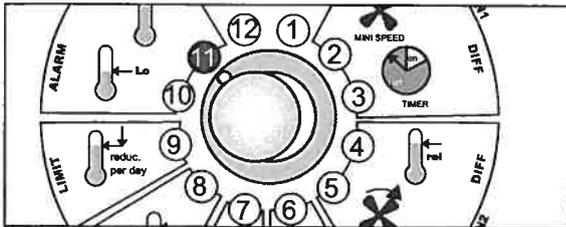
機能セレクトダイヤルを、異常温度警報設定ゾーンの機能番号⑪に合わせると、全機能の設定が完了し、現在までの最高室温を記憶・表示します。
