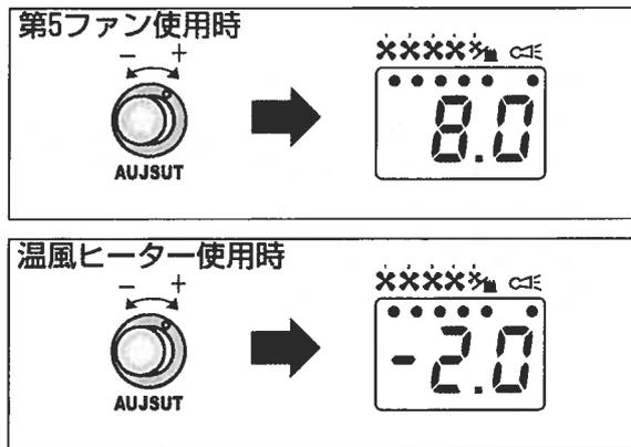
**3** アジャストダイヤルを回して、作動開始温度を設定します。
