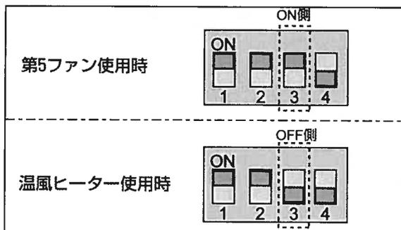
**2** ディップスイッチを以下の使用状況に合わせて切り換えます。
