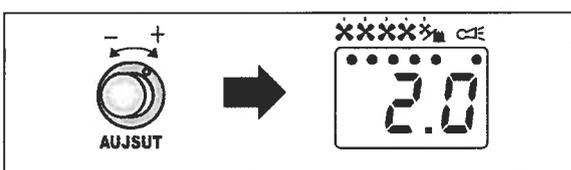
**2** アジャストダイヤルを回して、第1ファンの最大回転速度の到達温度を設定します。
