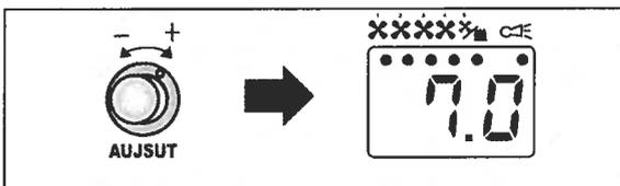
**2** アジャストダイヤルを回して、作動開始温度を設定します。
