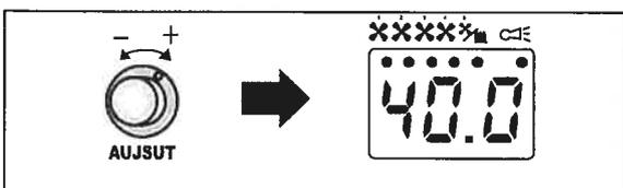
**2** アジャストダイヤルを回して、第2ファンの最低回転速度を設定します。
